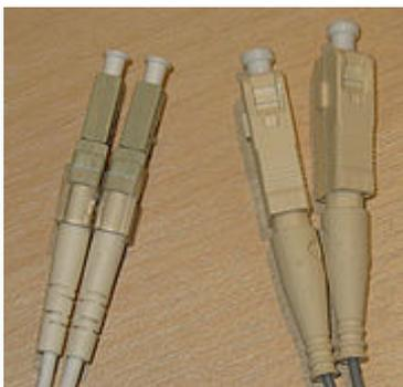
Рисунок ?? -Коннекторы **Fibre channel** - LC слева и SC справа
