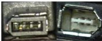
Как видно из фотографии, все контакты выведены в середину разъёма, а снаружи защищены толстым ободком из твёрдой пластмассы. Надёжность этой схемы доказана основательной его проверкой на устройствах GameBoy. Кроме того, имеется четырехконтактная версия разъёма без проводов питания.
