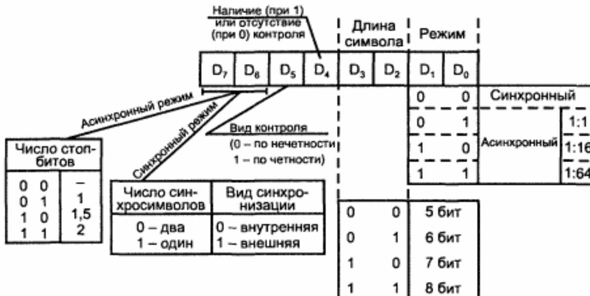
Рис. 6.11. Формат управляющего слова режима программируемого связного адаптера
