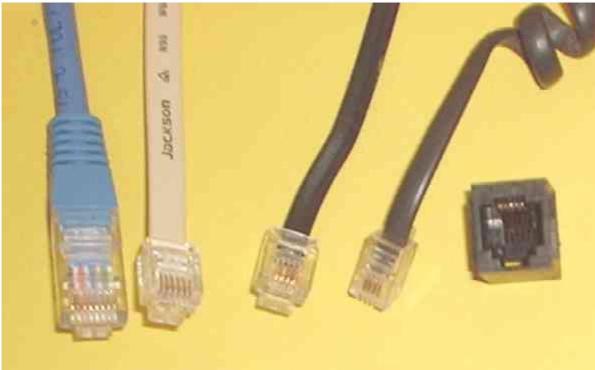
Слева направо, RJ-разъёмы: 8-контактный разъём (8P8C, использующийся [RJ49](#), [RJ61](#) и другими, но часто называемый «RJ45» из-за внешнего сходства с настоящим RJ45), 6-контактный RJ25, 4-контактный RJ14 (часто используется вместо 2-контактного RJ11) и 4-контактный [трансиверный](#) разъём (зачастую ошибочно называемый «[RJ22](#)», «[RJ10](#)» или «[RJ9](#)»). Те два, что посередине, могут быть вставлены в одну и ту же стандартную 6-контактную розетку (крайняя справа).
