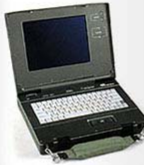
Baget-41 имеет герметичный алюминиевый корпус и защищенные клавиатурой, манипулятором и обзорным дисплеем. Предназначена для работы в полевых условиях.
